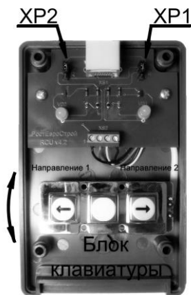
Вид пульта со снятой крышкой
