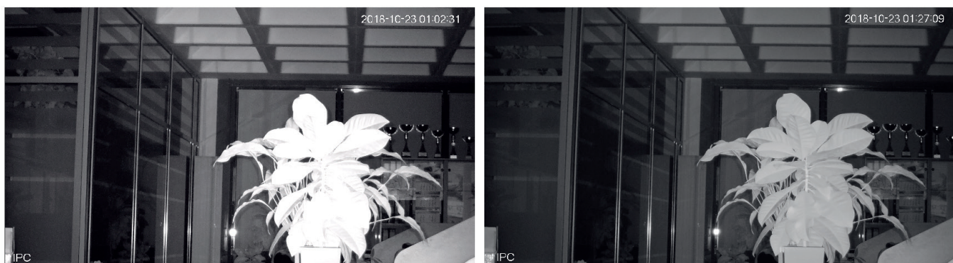
Рис. 4.18. Слева - обычная работа ИК-подсветки, справа - с функцией Smart IR
