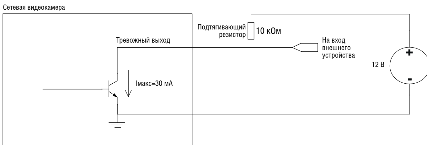
Рис. 4.50 Прямое подключение внешнего устройства к тревожному выходу видеокамеры
