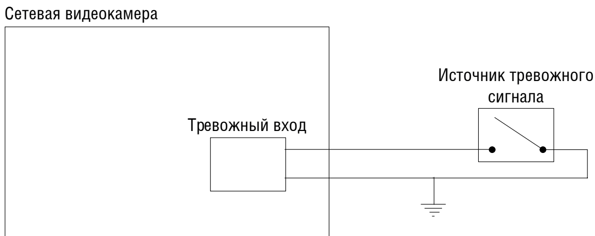
Рис. 4.52 Схема подключения тревожного входа сетевой видеочамеры
