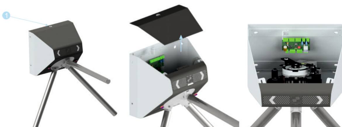
Рисунок 12.1.1. Демонтаж верхней крышки турникета.
