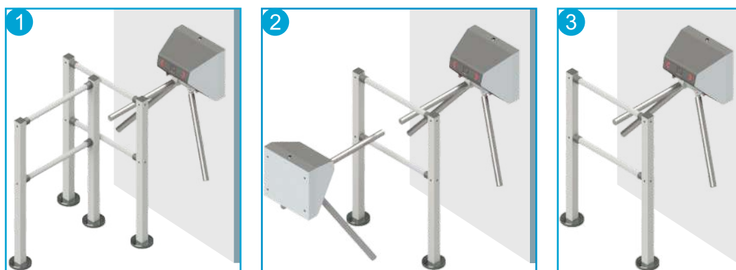
1 2 3 -турникет установлен правильно
